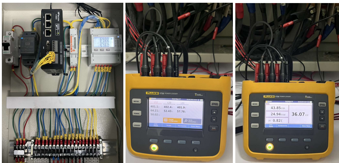
รูปที่ 6 การตรวจวัดพารามิเตอร์ทางไฟฟ้าด้วยพาวเวอร์มิเตอร์ Fluke 1738 Power Logger เปรียบเทียบกับชุดประมวลผลและแสดงผลการวัดพลังงานไฟฟ้าที่สร้างขึ้น
