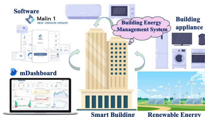
รูปที่ 1 ระบบตรวจวัดพลังงานไฟฟ้าในอาคารอัจฉริยะ
