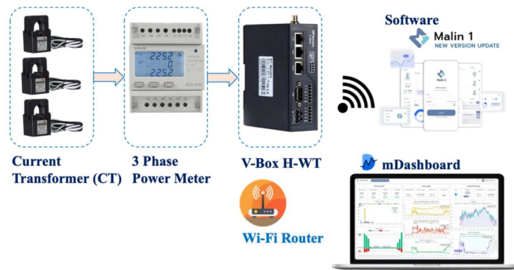
รูปที่ 2 ชุดประมวลผลและแสดงผลการวัดพลังงานไฟฟ้า
