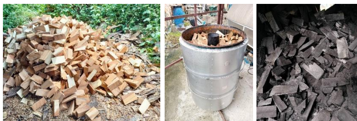
ภาพที่ 1 การนำเศษไม้จามจู้จากอุตสาหกรรมแปรรูปไม้ มาเผาในถัง 200 ลิตร
