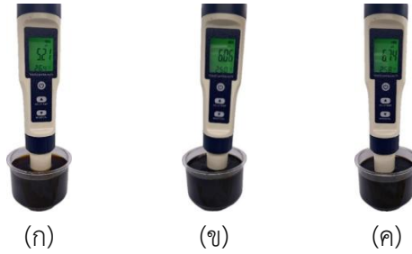
ภาพที่ 5 ผลการทดสอบวัดค่าความเป็นกรดต่างของน้ำใบยาสูบที่เวลาต่าง ๆ (ก) 30 นาที (ข) 120 นาที และ (ค) 180 นาที
