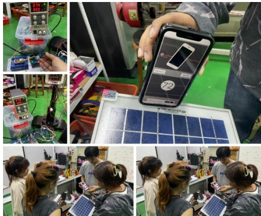
ภาพที่ 3 การทดสอบเซนเซอร์วัดมุมและแรงดันไฟฟ้าของระบบติดตามการทำงานของระบบติดตามดวงอาทิตย์
