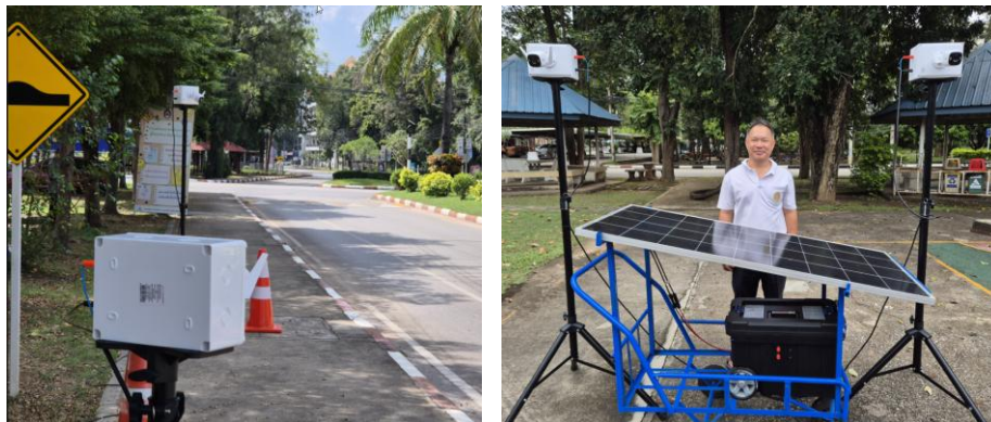
ภาพที่ 2 อุปกรณ์บันทึกกล้องแบบเคลื่อนที่และตำแหน่งจุดติดตั้งบริเวณทางเข้า (ที่มา: ผู้วิจัย, 2568)
