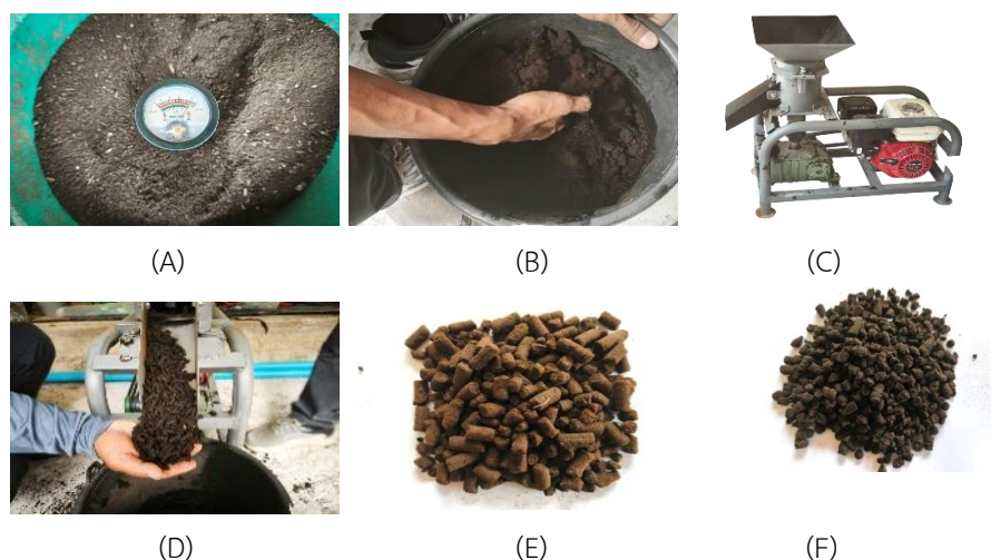
ภาพที่ 2 กระบวนการผลิตมูลแพะอัดเม็ด (A) มูลแพะที่ตีปนจนมีขนาดเล็ก (B) การเพิ่มความชื้นให้มูลแพะเพื่อให้สามารถจับตัวเป็นก้อนได้ (C) เครื่องอัดเม็ด (D) ลักษณะการผลิตเชื้อเพลิงอัดเม็ด (E) เชื้อเพลิงอัดเม็ดที่มีความชื้นสูง และ (F) เชื้อเพลิงอัดเม็ดที่มีความชื้นน้อยกว่าร้อยละ 12.14
