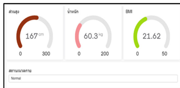
(ก) ผู้ทดสอบประเภทปกติ (ข) การแสดงผลบนตัวเครื่อง (ค) การแสดงผลบนแอปพลิเคชัน Blynk ภาพที่ 4 ผลการทดสอบระบบวัดค่าดัชนีมวลกายผ่านแอปพลิเคชันสมาร์ทโฟนประเภทปกติ
