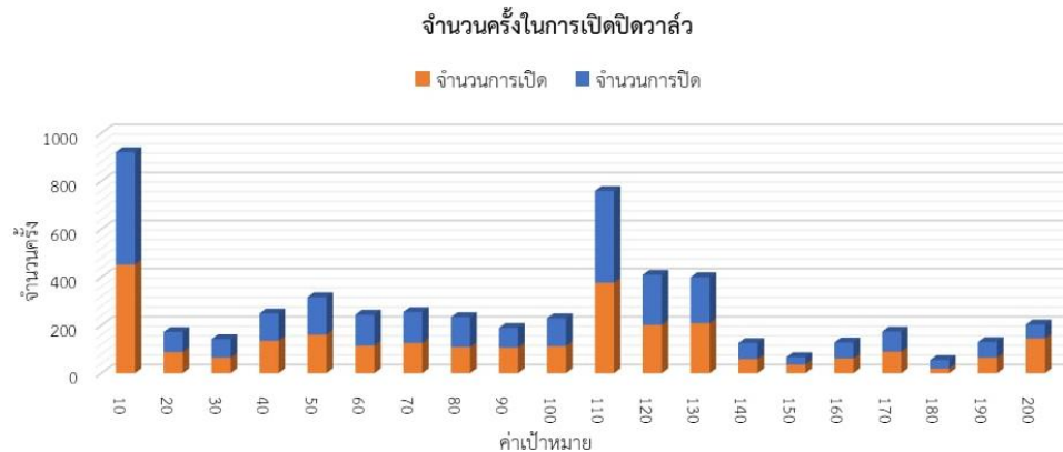
ภาพที่ 3 จำนวนครั้งในการเปิดปิดวาล์วไฟฟ้าควบคุมการไหลในแต่ละค่าเป้าหมาย
