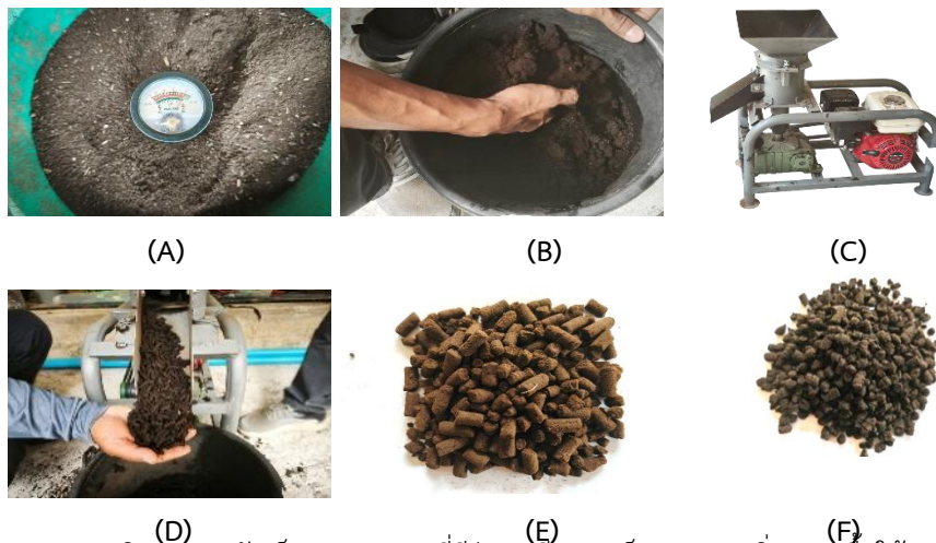
ภาพที่ 1 การเตรียมวัตถุดิบสำหรับการอัดเม็ดมูลแพะ (A) มูลแพะที่เหลือทิ้งจากกระบวนการเลี้ยงสัตว์ (B) มูลแพะที่คัดส่งปนเปื้อนออก และ (C) มูลแพะที่ผ่านกระบวนการตีปน
