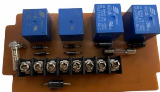
(ก) แผงวงจรที่ผลิตขึ้นเองพร้อมอุปกรณ์ รูปที่ 5 แผงวงจรควบคุมระบบติดตามดวงอาทิตย์ที่พัฒนาขึ้นพร้อมอุปกรณ์ที่ติดตั้ง
