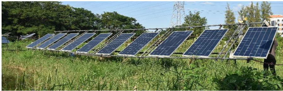
รูปที่ 6 โครงสร้างระบบติดตามดวงอาทิตย์ที่ใช้ทดสอบการทำงานชุดควบคุมที่พัฒนาขึ้น
