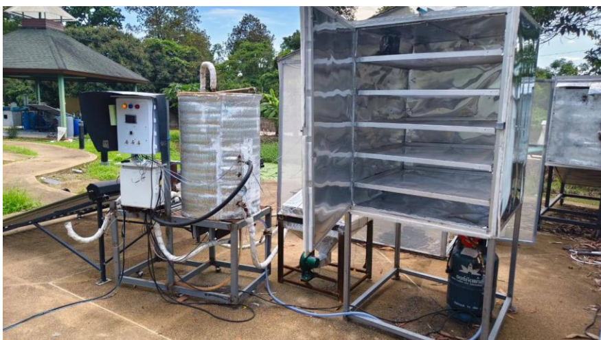
ภาพที่ 2 ระบบอบแห้งพริกโดยใช้แหล่งความร้อนจากพลังงานแสงอาทิตย์ร่วมกับก๊าซหุงต้ม
