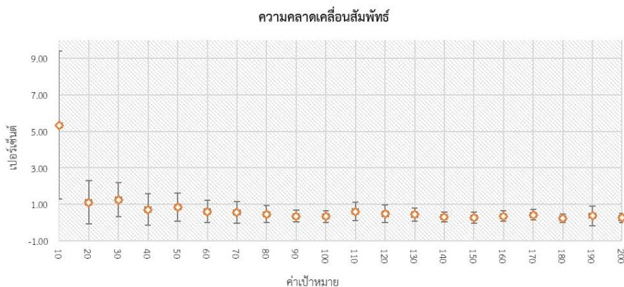
ภาพที่ 4 ความคลาดเคลื่อนสัมพัทธ์ของค่าอัตราการไหลในแต่ละค่าเป้าหมาย
