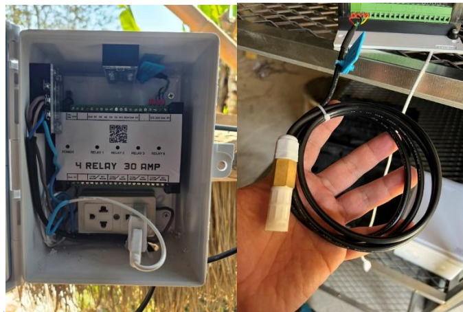
รูปที่ 2 การต่อESP8266 เข้ากับเซ็นเซอร์ SHT21
