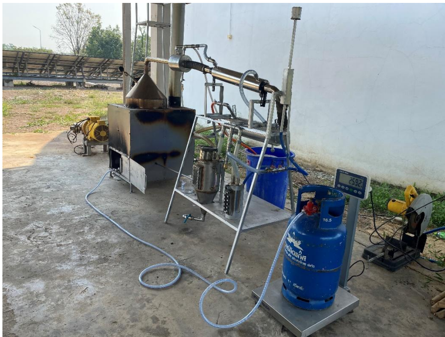
ภาพที่ 3 แสดงระบบเตาไฟโรไลซิส
