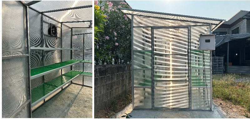
ภาพที่ 2 โรงอบแห้งพลังงานแสงอาทิตย์ที่ใช้ในการทดลองในงานวิจัยนี้
