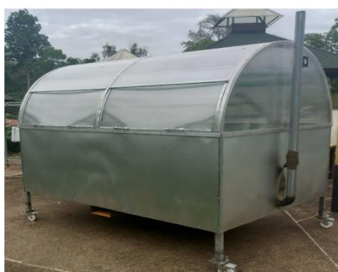
ภาพที่ 3 ลักษณะเครื่องอบแห้งพลังงานแสงอาทิตย์ร่วมกับพลังงานชีวมวล
