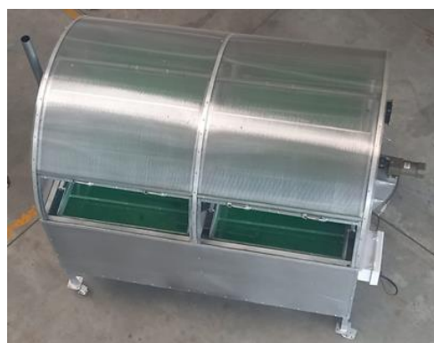
ภาพที่ 3 ลักษณะเครื่องอบแห้งพลังงานแสงอาทิตย์ร่วมกับพลังงานชีวมวล
