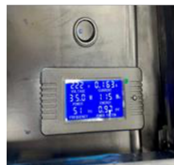
ค) ทดสอบการทำงานของบอร์ด PZEM-016 และ PZEM-022
