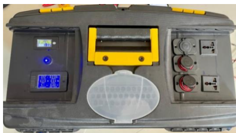
ภาพที่ 2 กล่องสำรองพลังงานไฟฟ้าแบบพกพาที่ได้ออกแบบและพัฒนาขึ้น
