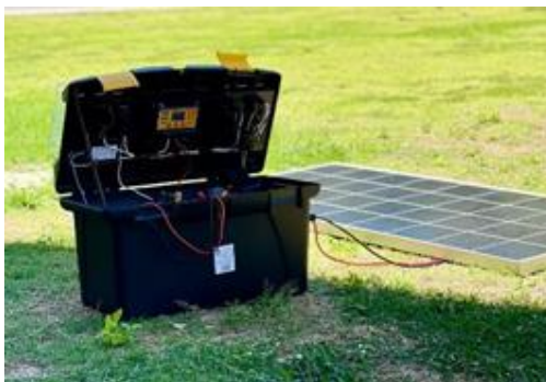
ภาพที่ 1 ต้นแบบกล่องสำรองพลังงานไฟฟ้าแบบพกพาที่ได้พัฒนาขึ้น
